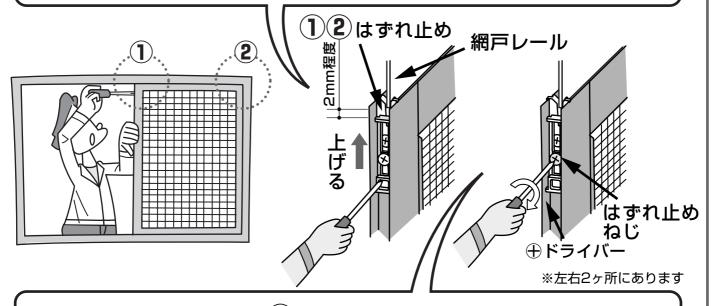
次にはずれ止めねじを(ナドライバーで強めに締めてください。
