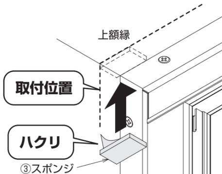
③たて枠アタッチメント上下端のハクリ紙をはがし、スポンジに押し当ててください。
