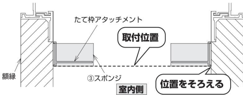
②スポンジのハクリ紙をはがし、たて枠アタッチメント取付位置上部に貼付けてください。
