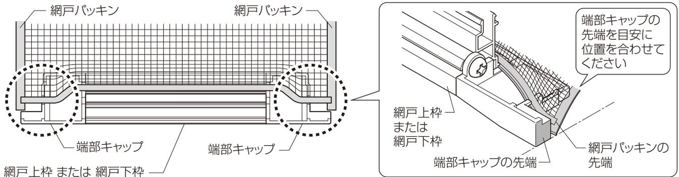
※網戸上枠(または下枠)の端部キャップから網戸パッキンが外れている場合、はめ込んでください。はめ込みされていないと、網戸枠が最後まではめ込みできなくなります。
