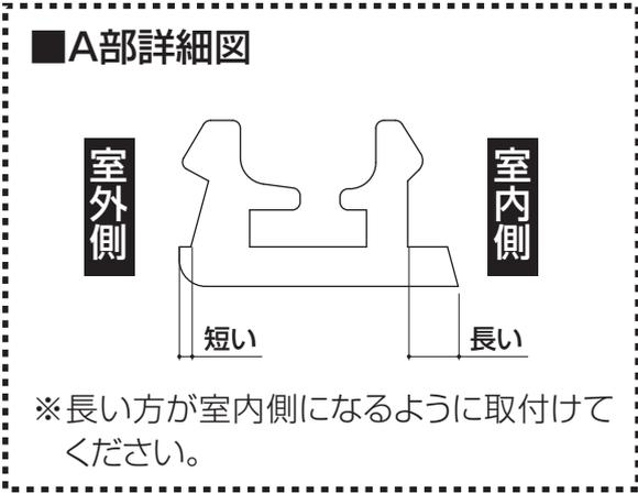
②溝カバー横用の両端部を先に下枠(又は上枠)に取付けて、縦枠側にスライドさせてください。
